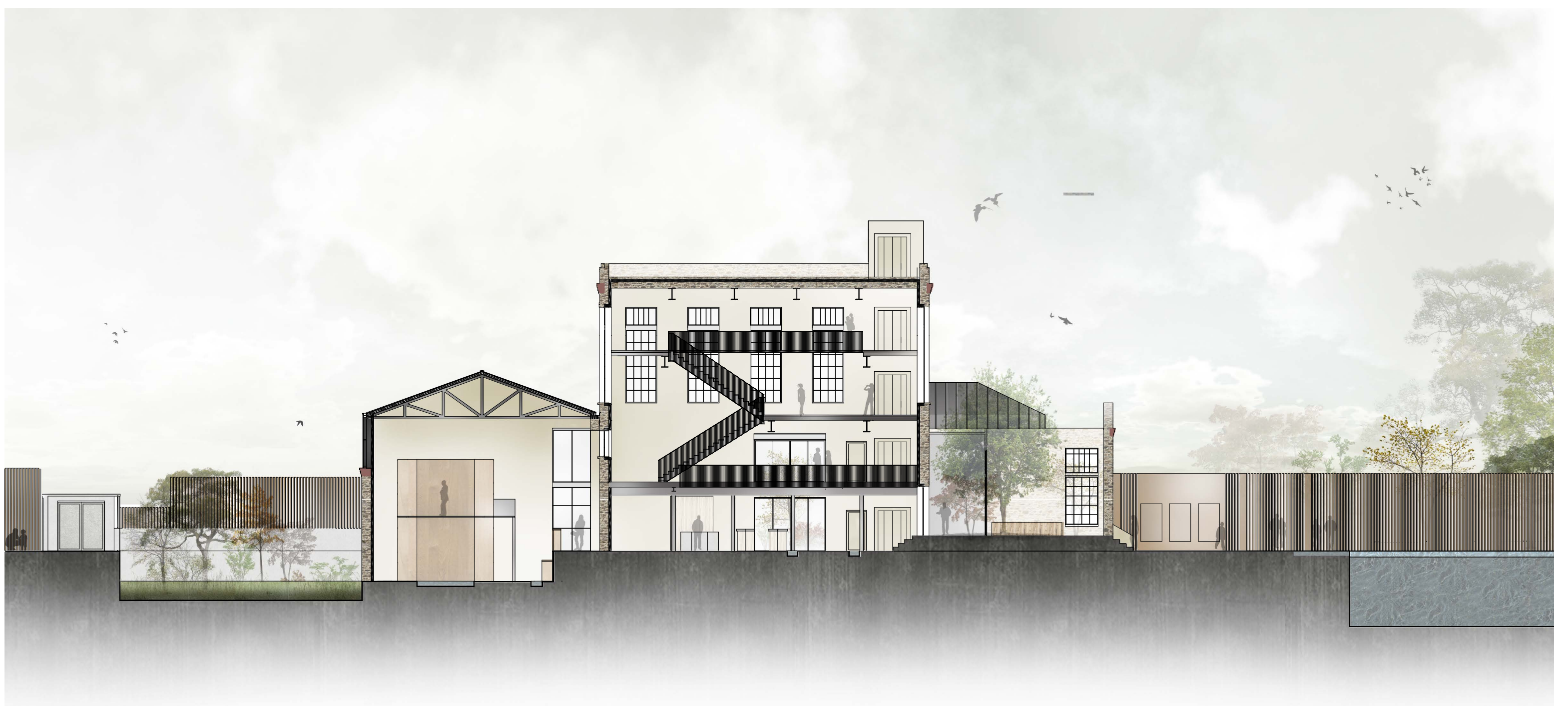
UN RAPPORT AU SOL ET AU CIEL : COMPOSER AVEC LES ÉVOLUTIONS SUCCESSIVES DE L'ANCIENNE DISTILLERIE - COUPE LONGITUDINALE - ÉCH 1:200
