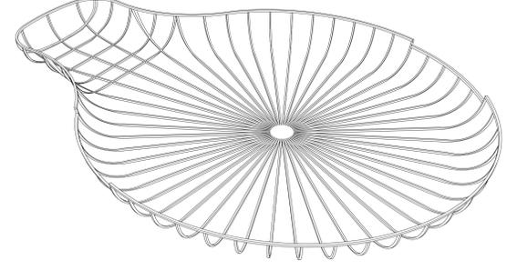
Axonométrie de la structure de la coque
