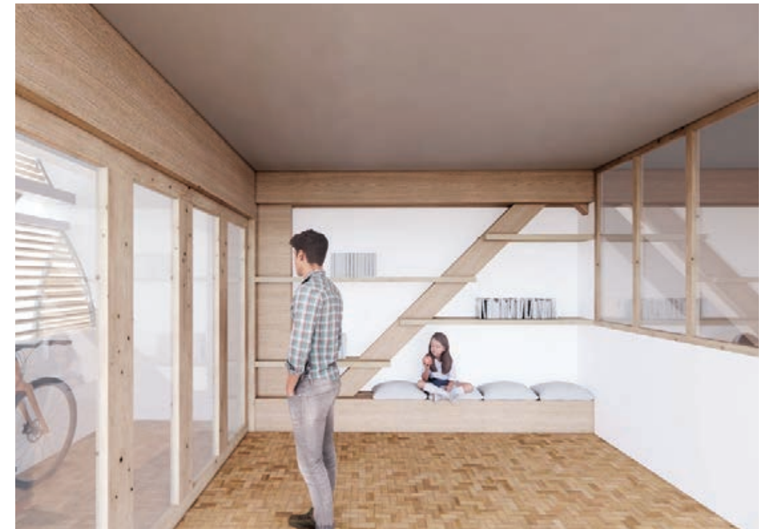
Perspective d'un logement réhabilité (le portique en bois, permettant à la surélévation d'être auto-portante devient dans l'espace une épaisseur habitée)
