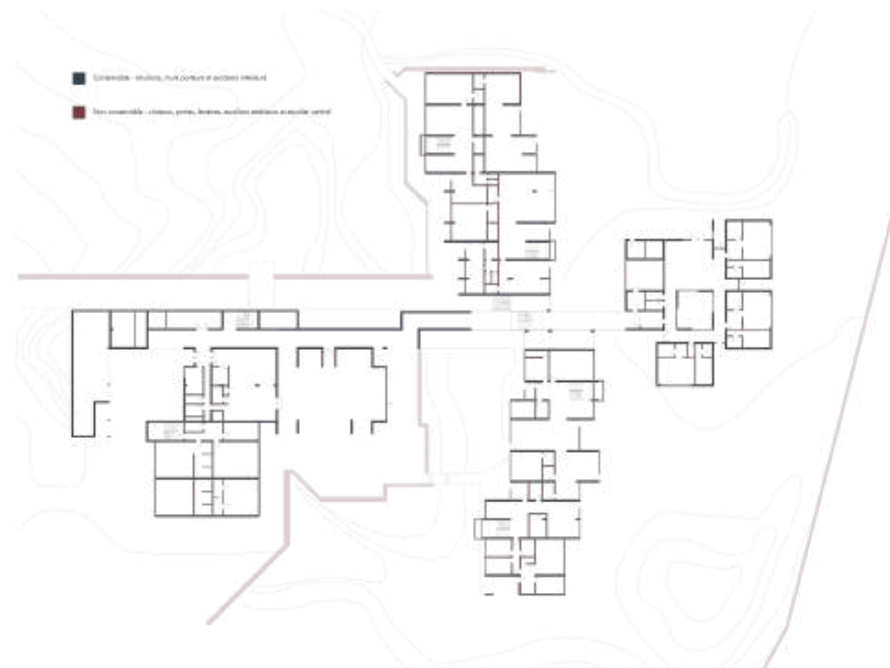
Plan de conservation et démolition du rez-de-chaussée.
