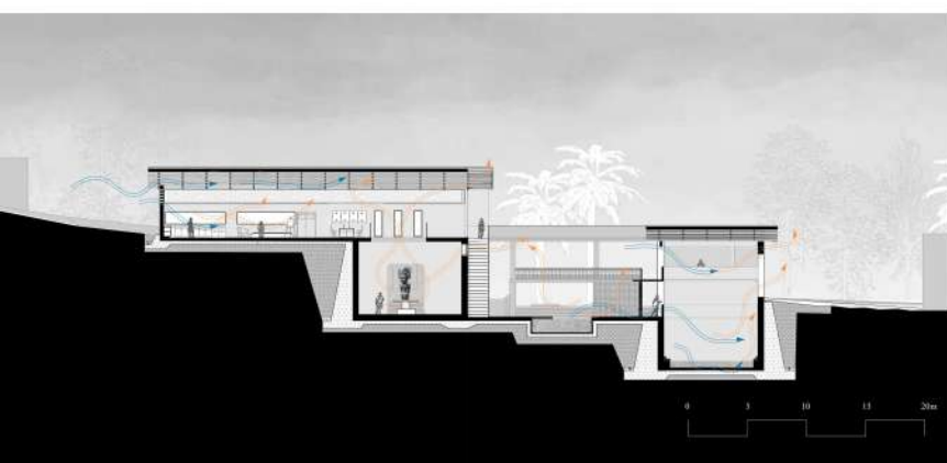
COUPE B.B Mouvement typique du vent sur le site
