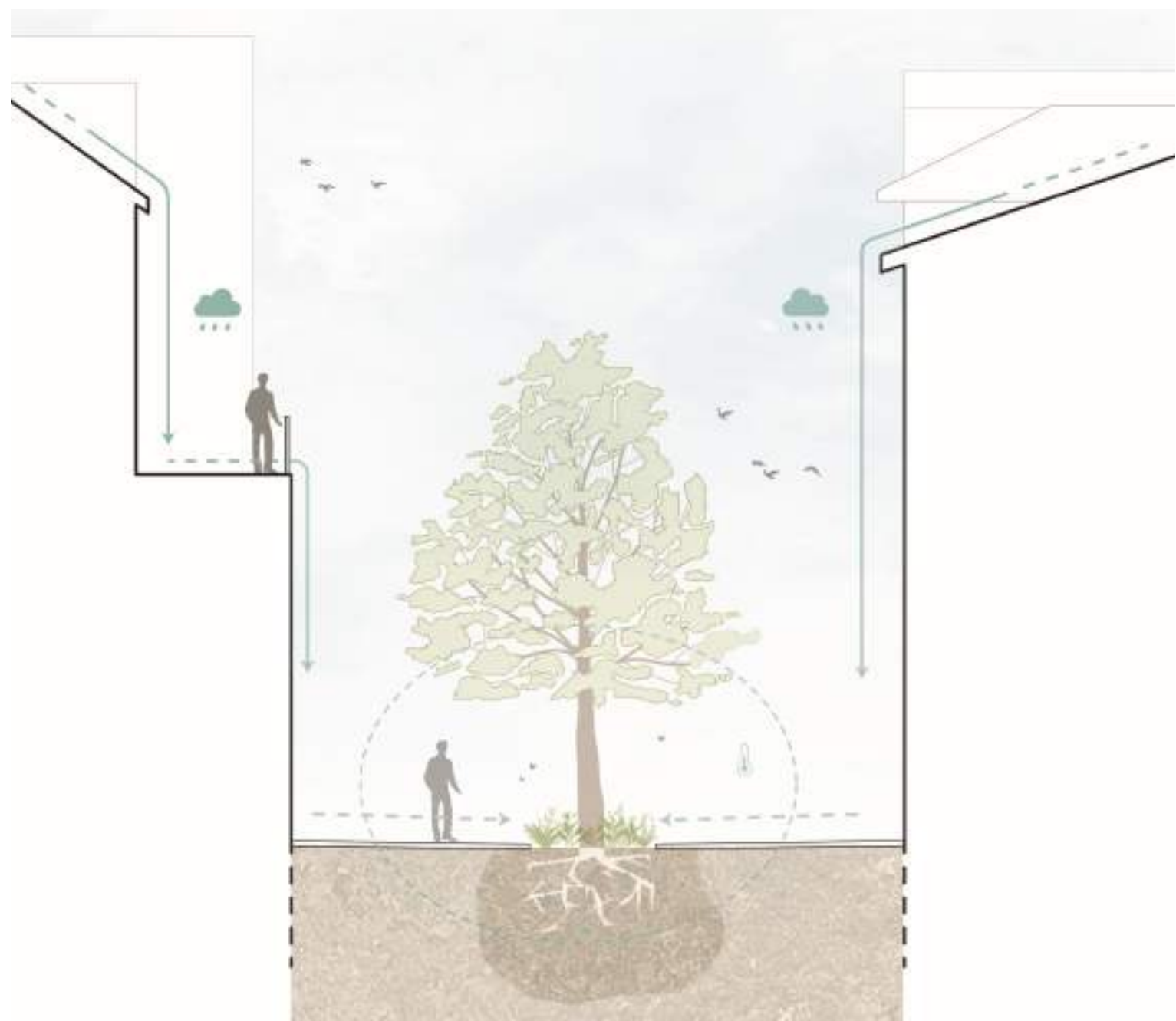
SCHEMA DU PRINCIPE DE RÉCUPÉRATION D'EAU DE PLUIE
