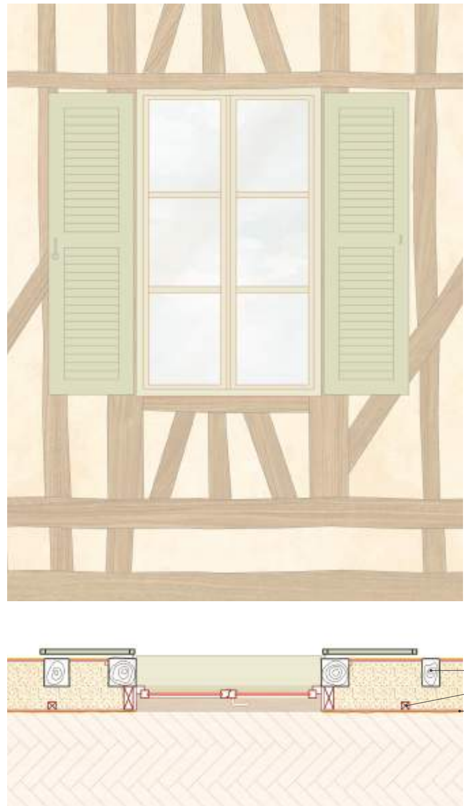
DÉTAIL DE L'ISOLATION DES BÂTIMENTS EN PANS DE BOIS DE L'ÎLOT- 1/25
