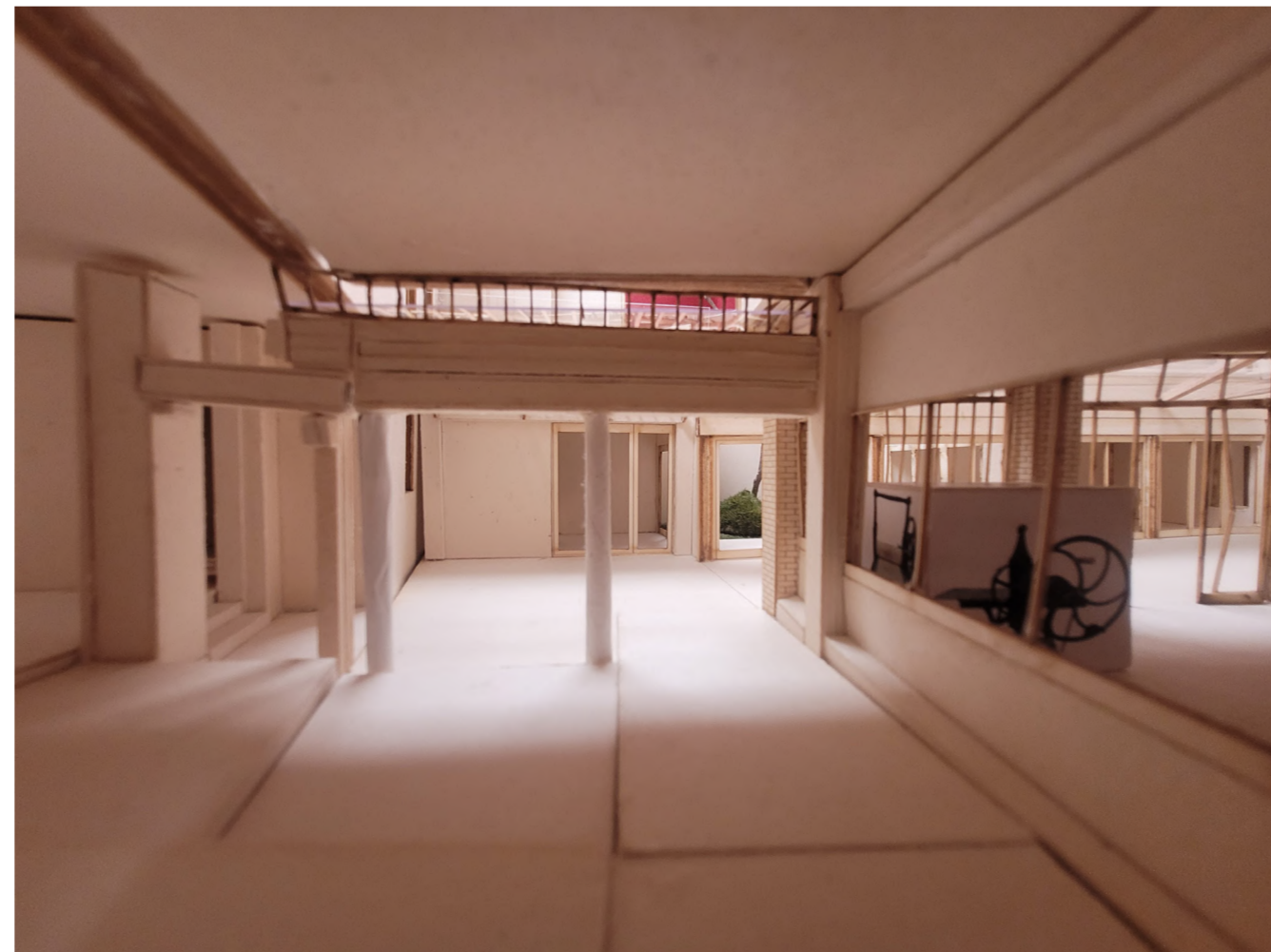
↓ La boutique est aménagée suivant un parcours rythmé par des paliers et rampes rattrapant le niveau de la place et celui des ateliers (environ 40cm plus bas).
