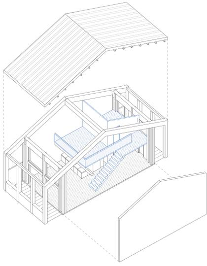
2 Une mezzanine sur un demi niveau permet d'ajouter une chambre et/ou un bureau/atelier et de conserver une double hauteur
