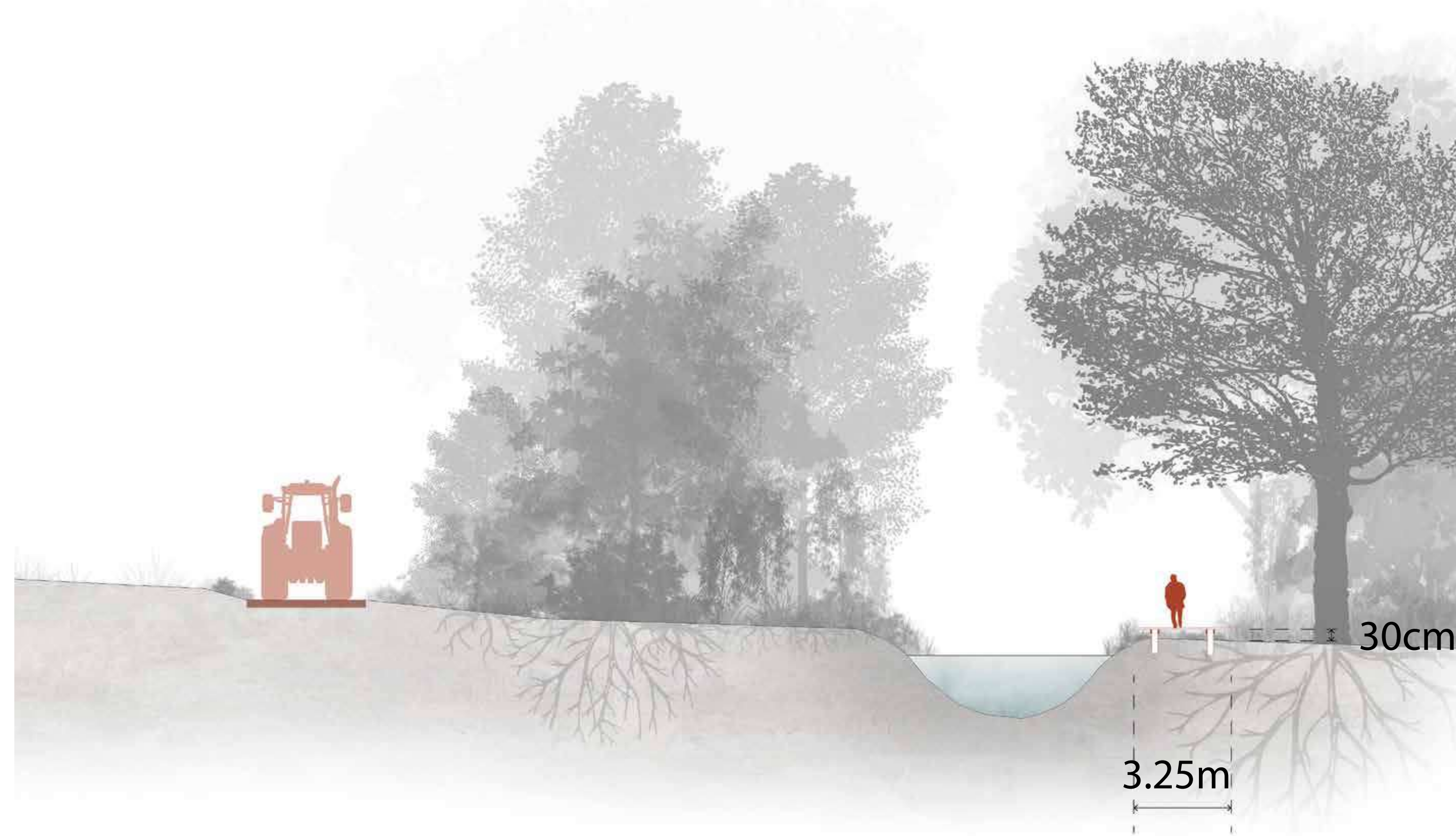
SURÉLEVER LE SENTIER PAR DES PONTS PERMETTANT DE TRAVERSER LES ZONES MARÉCAGEUSES / ECH 1:200
