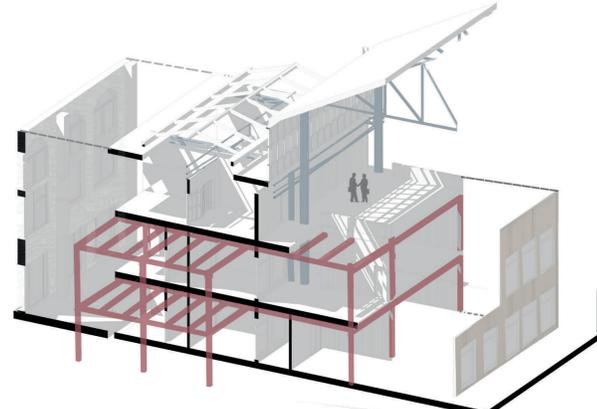
Axonométrie , module de structure entre nef et bas côté
