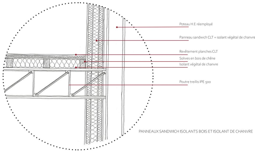
PANNEAUX SANDWICH ISOLANTS BOIS ET ISOLANT DE CHANVRE
