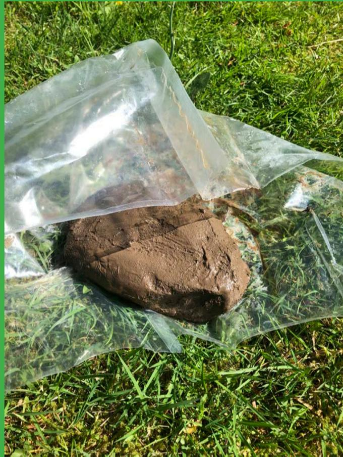
Afin d'éliminer un maximum d'air et d'eau j'ai laissé reposer la terre durant toute la nuit puis je l'ai retravaillée le lendemain. Afin de ne pas la sécher totalement je l'ai recouverte d'un sac plastique. Le lendemain lorsque j'ouvre le sac j'aperçois de la condensation, donc de l'humidité et la terre est également très chaude.
