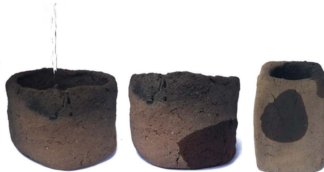
Pour tester l'étanchéité des poteries j'ai versé de l'eau dans les deux essais. Pour le premier essai, la poterie absorbe pratiquement la totalité de l'eau. Puis pour le second essai l'eau est absorbée mais moins rapidement que dans le premier essai.
